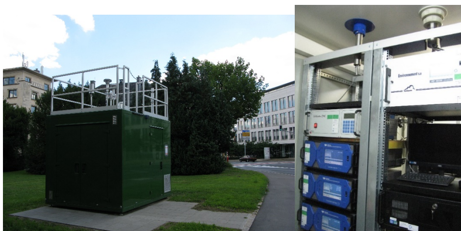
Измервателна станция на качеството на атмосферния въздух и пунктове за мониторинг (сините устройства на снимката вдясно)
